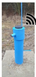
Obrázek 4 Měření hladiny s VW sondou a s odesláním dat pomocí SENSECOM-HP1
