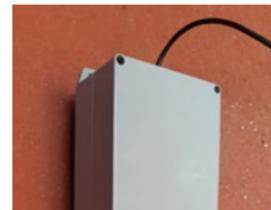
Obrázek 5 SENSECOM-HPC pro měření z až 5 VW sond a odesílání dat přes IoT síť
