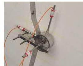
Obrázek 6 Měření trhlin ve stavebnictví se 3 sondami
