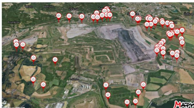
Obrázek 7 Monitoring hladin spodních vod (a pórových tlaků hornin) na jednom z areálů Severočeských dolů a.s.
